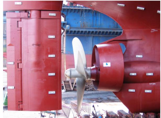
Abbildung 16 Mewis Duct®, montiert am Hinterschiff eines 45.000 DWT Mehrzweck-Frachters, Propellerdurchmesser 7 m.
