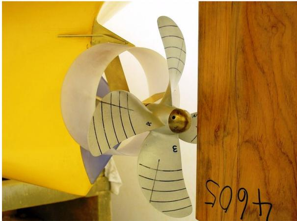
Abbildung 14 HSVA - Modell einer Mewis Duct®, 45.000 DWT Mehrzweck-Frachter
