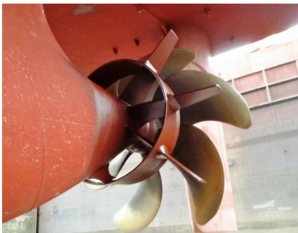
Abb. 9. Die erste installierte BMDT (BTF) an einem 7.090 TEU Containerschiff der Reederei Hamburg Süd, Leistungseinsparung durch BMDT: 3,8 %, Dezember 2012, Foto: BMS
