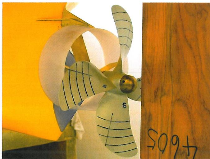
Abb. 1: HSVA-Modell einer MD, 45 000 tdw Open Hatch Bulker
