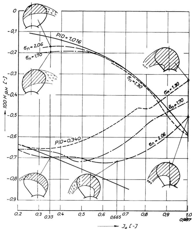
Bild 16. Flügelverstellmomentenbeiwert  $K_{QH}$  unter Kavitationseinfluß
