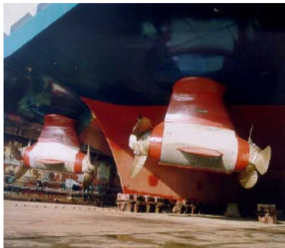
Abb. 7 Fähre „Nils Holgersson“ Antrieb mit SSP 2 x 11 MW
