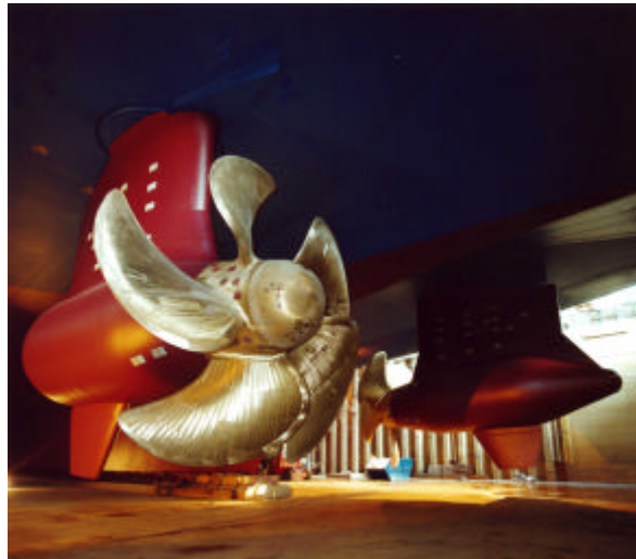
Abb. 4 Kreuzfahrtschiff "Radiance of the Seas" 2 Azipod-Einheiten, je 20 MW
