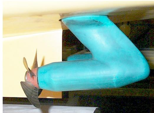
**Abb. 5:** ABB Compact Pod, 4.5 MW Modellversuch in HSVA Die eigenartige Strutforn ist allein aus Kühlungsgründen gewählt.
