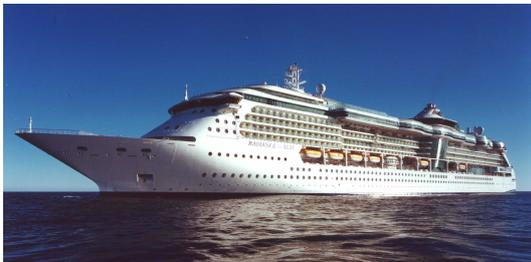
**Abb. 3:** Kreuzfahrtschiff „Radiance of the Seas“, Werft: Jos. L. Meyer GmbH, 2001, Azipod 2 x 20 MW
