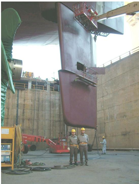
Abb. 7: Getwistetes Ruder eines 8400 TEU Containerschiffes (BMS-Design)
